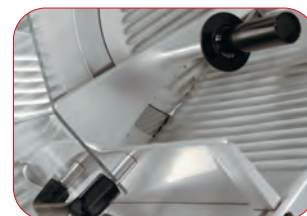
Protecciones de seguridad.
